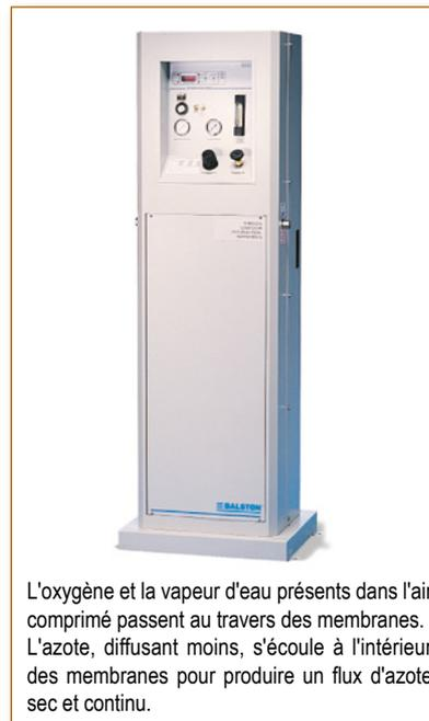
L'oxygène et la vapeur d'eau présents dans l'air comprimé passent au travers des membranes. L'azote, diffusant moins, s'écoule à l'intérieur des membranes pour produire un flux d'azote sec et continu.
