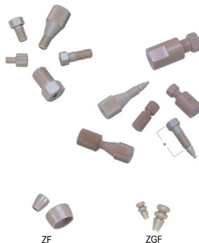
La nouvelle forme des ferrules ZGF augmente les points de contact entre la ferrule et le tube, elles sont recommandées lors de l'utilisation de PTFE et FEP.
