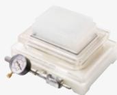
L'utilisation de plaques multi-puits nécessite l'emploi d'un appareil à vide dédié à ce type de consommables.
