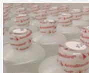
Etalons pour l'Absorption Atomique en éléments simples ou Multi-éléments
